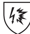
IEC 61482-2 APC 1 (KG 040, KG 041) en APC 2 bij twee kledinglagen (KG 041) (voorkant boven- lichaam/mouwen/voor- kant broekspijpen)
